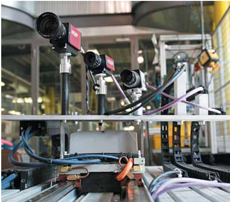
10米CFBUS.066 (USB 2.0) 安装在拖链, B10.015.100内, 与USB 2.0摄像头连接, 可实现350万次的往返运动。
